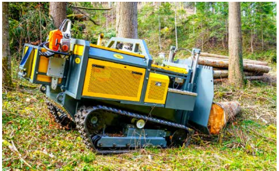
Raupenseilwinde RT 55.2 / Foto Firma Alther
